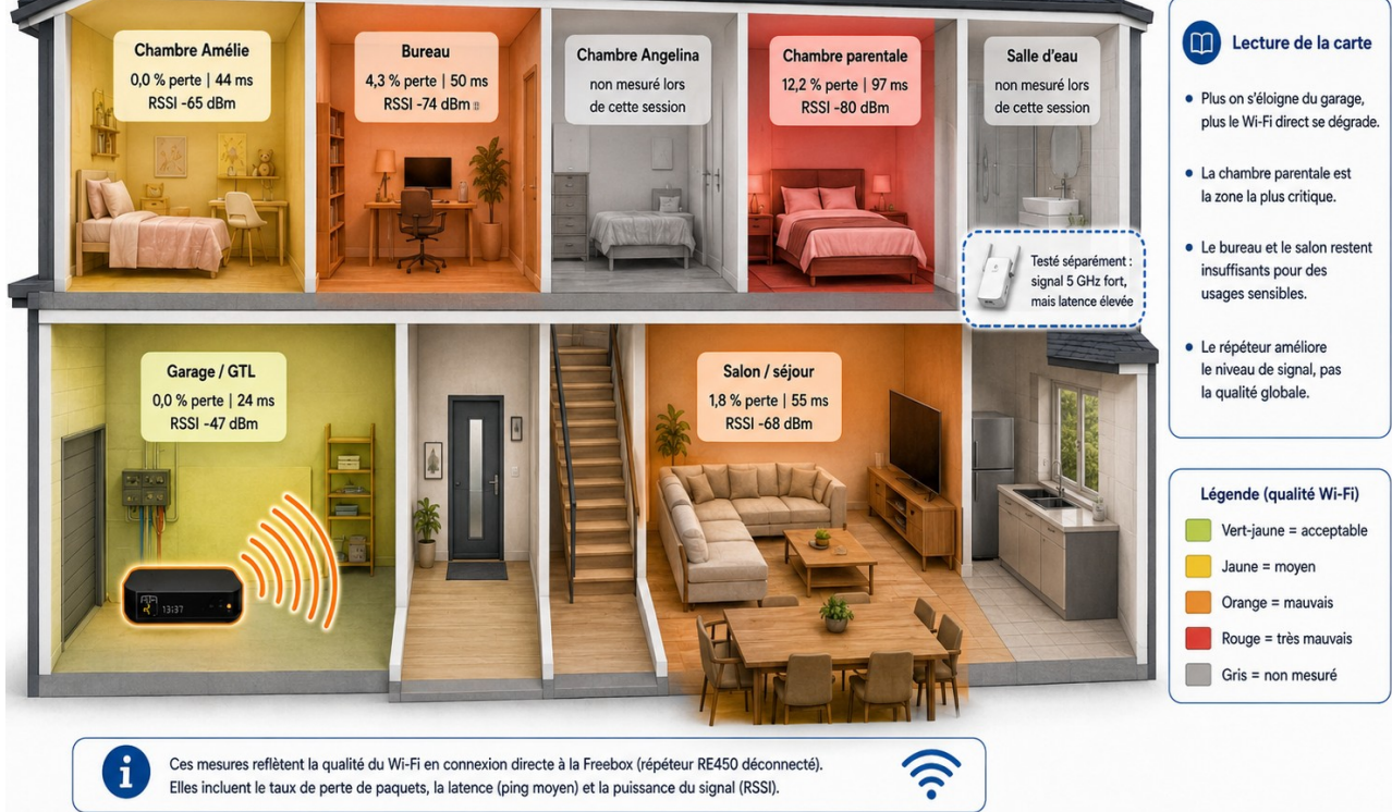
Figure 3 - Cartographie de qualité Wi-Fi directe Freebox, TP-Link RE450 débranché. La chambre Angelina est intégrée au tableau de synthèse.
